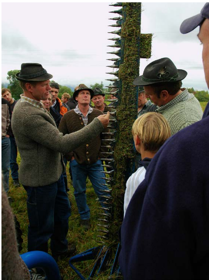
Abb. 4: Mähbalken haben sich in zahlreichen Untersuchungen als für die Fauna schonendste Mähvariante herausgestellt.
